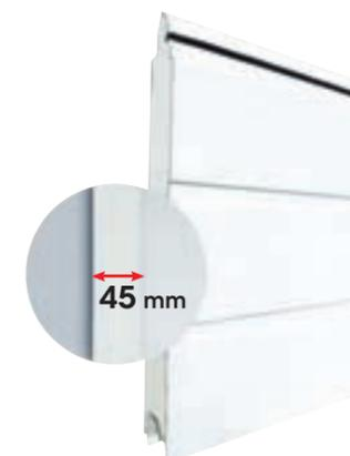
**Isolation et confort** : constitués d'un panneau sandwich de 45 mm de mousse de polyuréthane sans CFC, entre deux tôles d'acier galvanisé et prélaqué.
